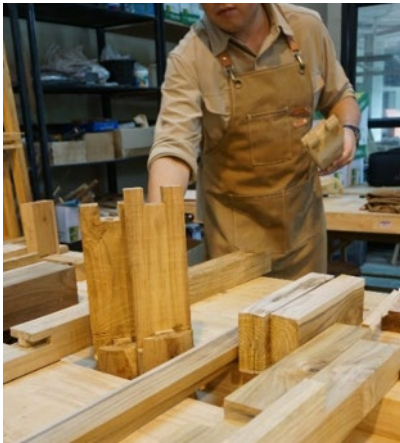
รูปที่ 1 บรรยายการลงมือทำแบบจำลอง โครงสร้างไม้ขนาดเกือบเท่าขนาดจริง
