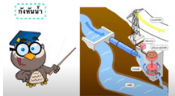
รูปที่ 11 การอธิบายหลักการทำงานและอุปกรณ์ที่สำคัญในโรงจักรไฟฟ้าพลังน้ำ
